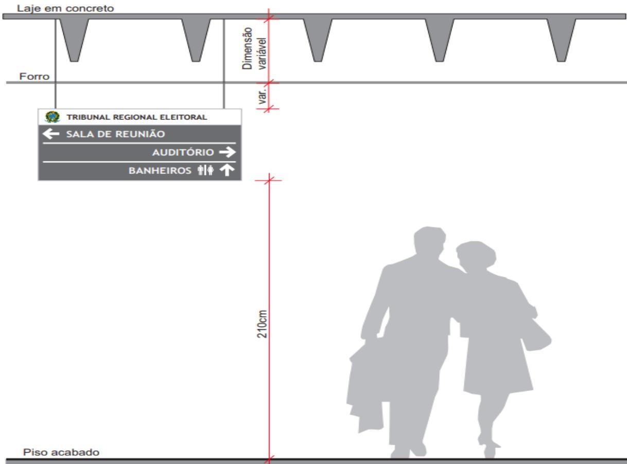
**4.2 Item 2: Quadro Geral de Pavimentos** – Placas em chapa de alumínio composto de 3mm, na cor cinza. Letras, pictogramas e setas em vinil de alta performance nas cores indicadas, acabamento com uma demão de verniz PU e fixadas com trilho parafusado à parede, conforme o modelo abaixo: QUANTIDADE – 09 UNIDADES
