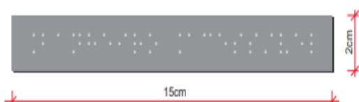
Plaqueta braile em alumínio natural com texto em alto relevo prensado, fixado por fita duplace diretamente na placa de ACM
