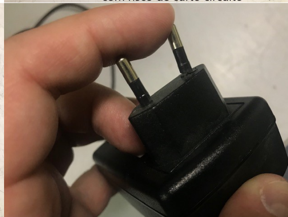
fontes consertadas - gambiara com risco de curto circuito
