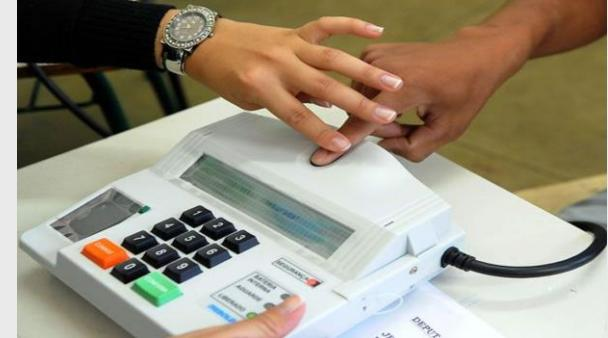
Realiza a coleta de dados biométricos por meio de sensores que os convertem em arquivo de formato digital.
