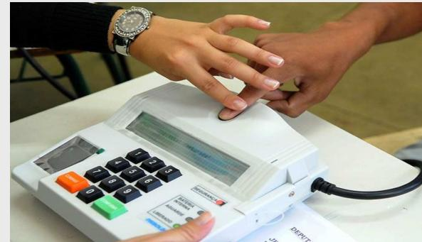
Realiza a coleta de dados biométricos por meio de sensores que os convertem em formato digital.
