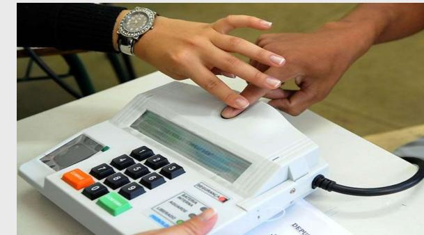
Realiza a coleta de dados biométricos por meio de sensores que os convertem em formato digital.
