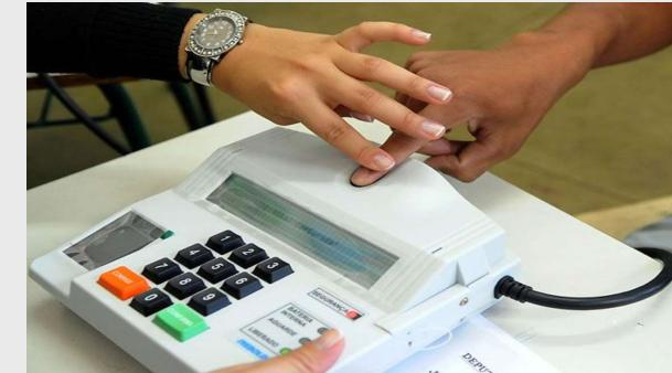
Realiza a coleta de dados biométricos por meio de sensores que os colocam em formato digital.
